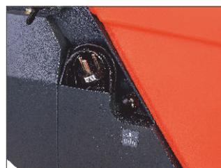
Поставляется со встроенным зарядным устройством. Машина оснащена электромагнитным клапаном подачи моющего средства.
