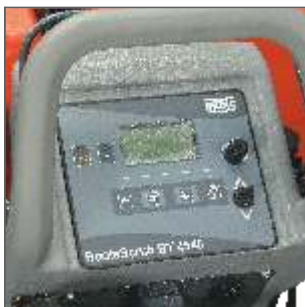
Эргономичная ручка для оператора. Пульт управления с понятными символами и индикацией режимов работы. ЖК-панель с указанием времени наработки и уровня заряда батарей.
