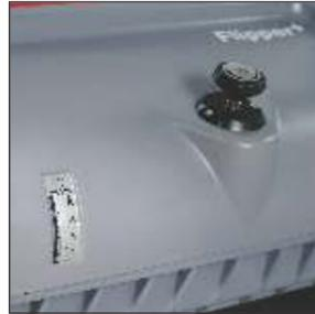
Регулировка щетки. Прижатие главной щетки регулируется специальной ручкой, что позволяет добиться идеальных результатов уборки в зависимости от типа убираемой поверхности и уровня ее загрязнения.
