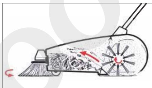
Наружная подметальная щетка идеально подметает мусор в труднодоступных местах и направляет его под главную роликовую щетку. Роликовая щетка вращается против движения подметальной машины, одновременно подметает поверхность и направляет мусор в специальный бак для мусора
